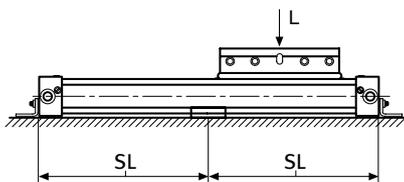
max. Stützlänge (SL) in mm - ohne Mittenstücke Nr. 25
