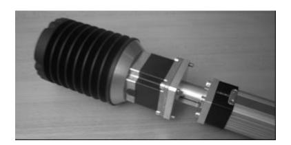
Der Adapterflansch macht den Anbau eines nicht direkt anflanschbaren Getriebes oder Motores möglich.
