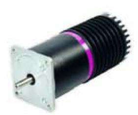
Bei diesem Schrittmotor werden nur ein Netzkabel und eine Steuerleitung benötigt. Alles andere wie Geber, Geberelektronik, Netzteil, Motor-Endstufe und Mikroprozessor-Steuerung befindet sich im speziellen Kühlgehäuse am Ende des Motors.
