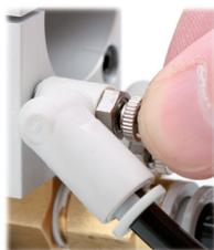
Die Einstellung der Vor- und Rückhubgeschwindigkeit kann mittels Abluftdrosseln eingestellt werden. Vorher sollte, wegen der besseren Zugänglichkeit die Ablufthülse demontiert werden.
