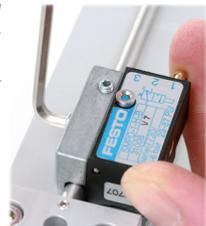
Optional können Endlagen-schalter auf der Sensorstange montiert werden. Diese sind auf dieser Stange verschiebbar. Die Endlagen-schalter gibt es in den Versionen: pneumatisches und elektrisches Signal.
