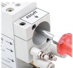
Die Einstellung der Bremsgeschwindigkeit erfolgt an der innen liegenden Hydraulikbremse mit einem Schlitz-Schraubendreher. Vorher sollte, wegen der besseren Zugänglichkeit die Ablufthülse demontiert werden.
