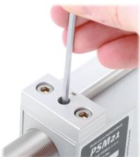
Die Klemmung der Hubeinstellschraube erfolgt mittels einer mit einem Messingkopf versehenen Madenschraube. Vor dem Einstellen des Gesamthubes muß diese Schraube mit einem Inbusschlüssel gelöst werden.
