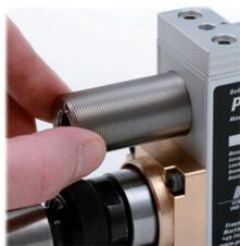
Der Gesamthub wird mit der Hubeinstellschraube eingerichtet. Diese Einstellschraube hat ein Feingewinde mit 1 mm Steigung. Dadurch kann die Vorschublänge sehr genau eingestellt werden.
