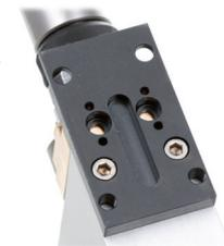
Die Befestigung der Bohrvorschubeinheit kann von oben oder von unten erfolgen. Zur fluchtgenauen Montage ist eine Passfeder vorgesehen. Die Einheit kann außerdem mit Passstiften verstiftet werden.
