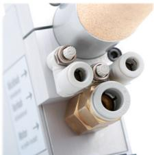
Die Druckluftanschlüsse sind zentral an der Rückseite platziert. Für Vor- und Rückhub soll ein Schlauch mit 6 mm Außendurchmesser und für den Motorschluß ein Schlauch mit 10 mm Außendurchmesser verwendet werden.
