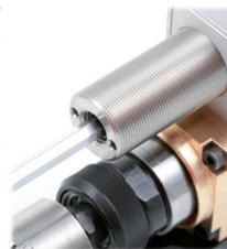
Die Einstellung der Bremslänge (Arbeitsvorschub) erfolgt mittels Druckschraube. Dieser ist mit einer Long-Lok Gewindesicherung versehen, so dass ein Verstellen während des Betriebes verhindert wird.
